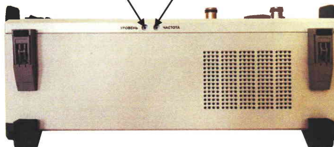
Рисунок 2 - Схема пломбировки от несанкционированного доступа, обозначение мест нанесения знака поверки.
