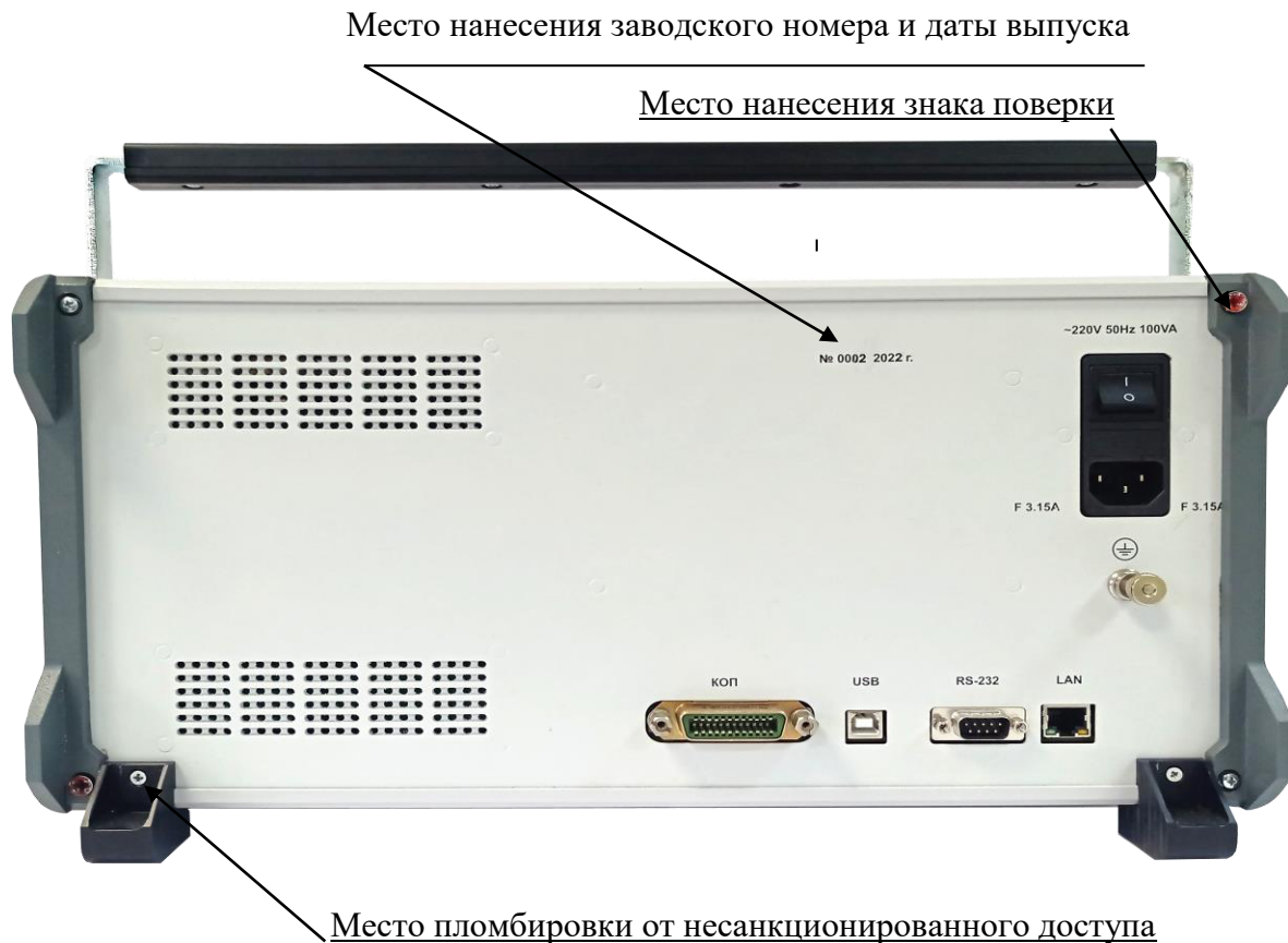
Рисунок 2 - Схема пломбировки от несанкционированного доступа, обозначение мест нанесения знака поверки, заводского номера и даты выпуска
